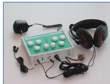
Рис.3.9. Аппарат звукоусиливающий «Глобус» с модулем вибротактильного восприятия
