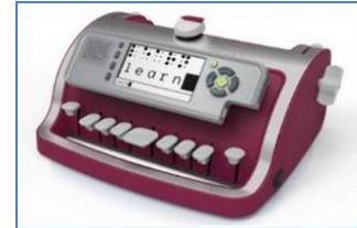
Рис. 3.16. Пишущая машинка Брайля с экраном
