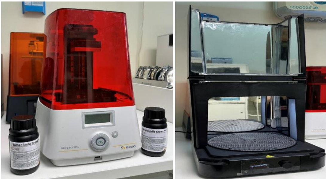
Новое оборудование зуботехнической лаборатории для изготовления моделей и несъемных конструкций из композитной керамики
